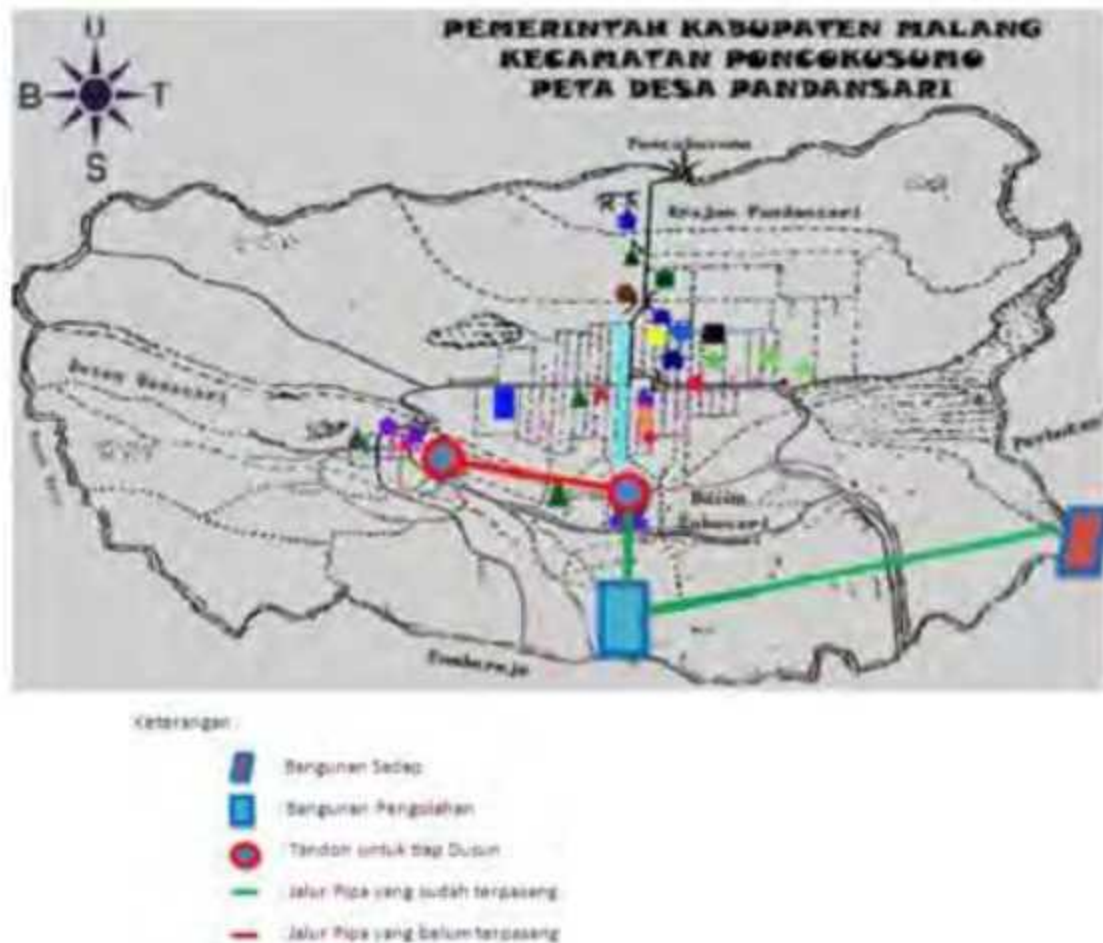
Gambar 4. Skema jalur pipa distribusi dari bangunan sadap ke bangunan bak penampungan sementara
