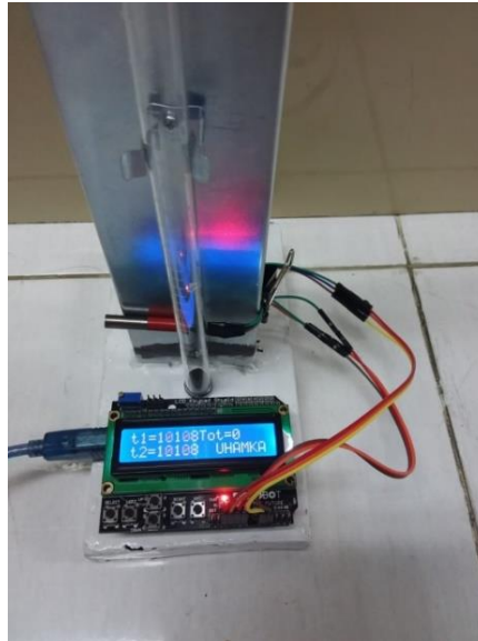
Gambar 2. Pemanfaatan Sensor Efek Hall untuk media pembelajaran Viskositas Zat Cair
