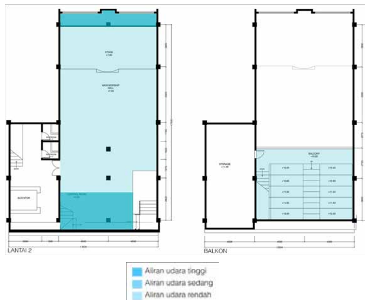
Gambar 14. Analisa Aliran Udara Lt. 3 dan Balkon Sumber: Dokumen olahan pribadi (2016)
