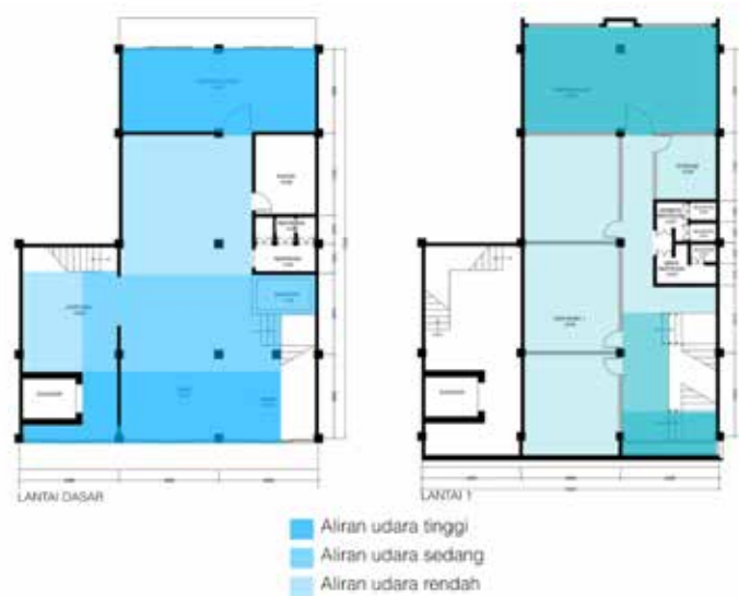
Gambar 13. Analisa Aliran Udara Lt. 1 dan Lt. 2 Sumber: Dokumen olahan pribadi (2016)
