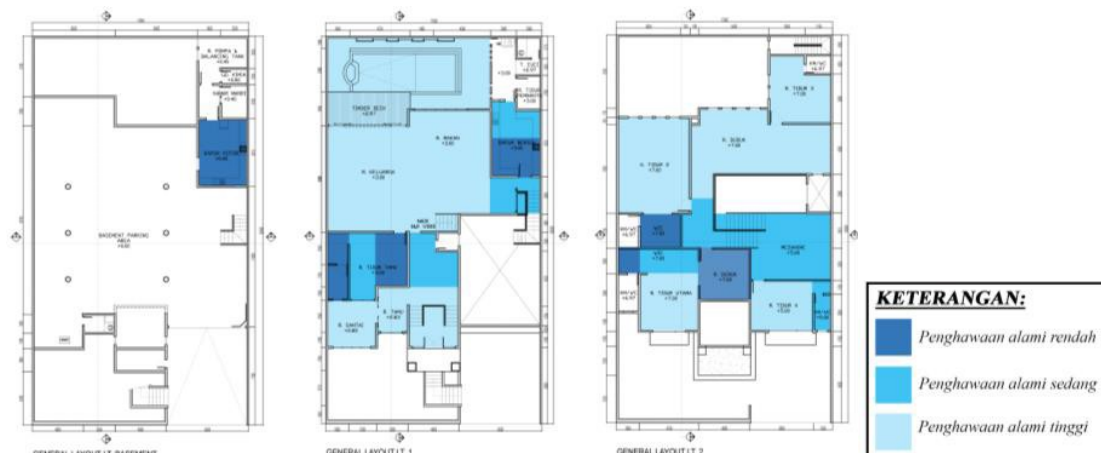
Figur 9. Analisa Penghawaan Alami Tapak Dalam Sumber: Olahan Analisa Pribadi (2017)
