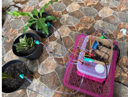
Gambar 11. Prototipe Sistem Penyiraman dan Pencahayaan Otomatis
