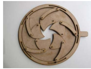
Gambar 12. Gambar Rencana Bentuk Opening dengan Prinsip Diafragma Kamera
